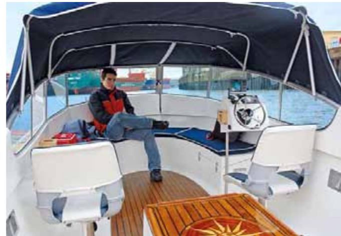
Ein Fahrverdeck wertet das Boot erheblich auf. Mit Zusatzpolstern entsteht in der Bugsektion des Skager-Cockpits eine Doppelkoje
