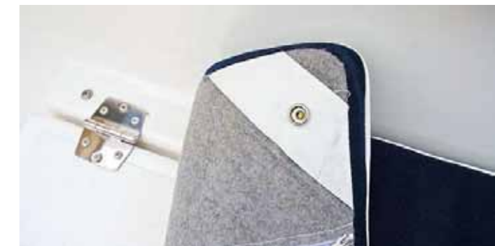
Die Polsterfixierung mittels Druckknöpfen beurteilen wir nicht als Ideallösung. Besser wären aus unserer Sicht solide Zuglaschen
