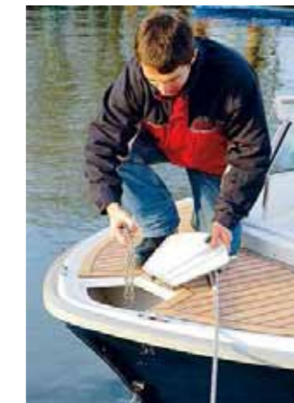
An der Bugspitze eingelassen: Der Ankerkasten ist vom Cockpit aus gut erreichbar
