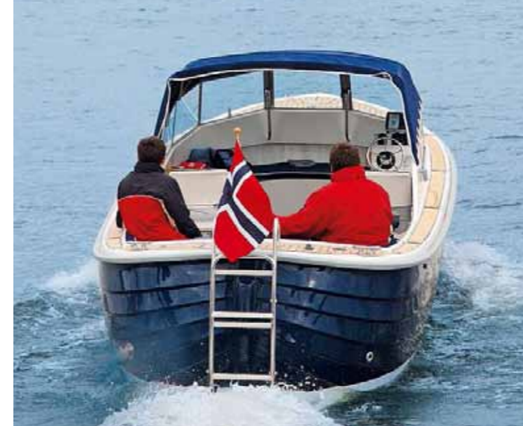
Skager 660 von achtern mit rundlich zulaufendem Klinkerrumpf
