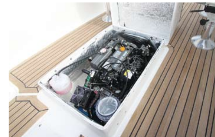
NESTEN SOM FØR: Det er bare den lille el-motoren på utgående aksel som gjør den store forskjellen.
