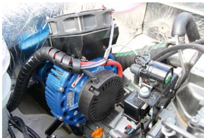
KAN ETTERMONTERES: Denne el-motoren gjør båten om til hybridbåt.
